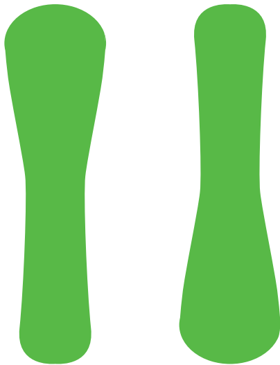
Tapa de aire o aguja obstruidos o dañados
