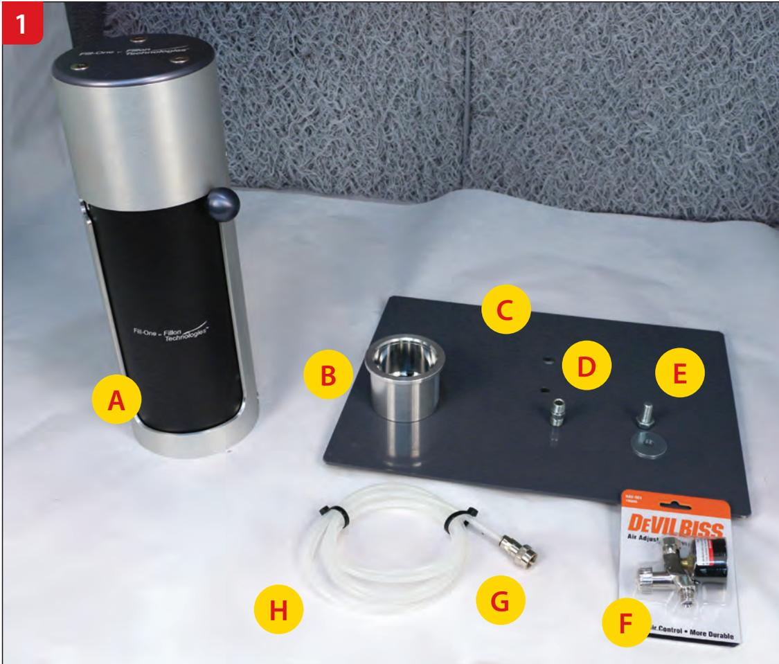
Compruebe que dispone de los siguientes equipos: Máquina de llenado (A), copa metálica del cilindro (B), placa base (C), niple doble macho (D), perno corto (no perno largo) y arandela (E), manómetro de aire (F), conector rápido (G), manguera de aire (H)
