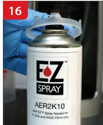
16 Coloque el anillo adaptador de plástico en la parte superior de la lata de aerosol llenada.
