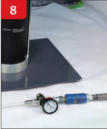
Haga todas las conexiones de la línea de aire desde la máquina al manómetro y al suministro de aire como se muestra arriba.
