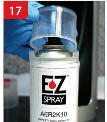
17 Coloque la copa de plástico de llenado con color visible en la parte superior de la lata de aerosol.
