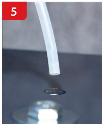
Pase la línea de aire para la máquina a través de la parte inferior de los agujeros descentrados hacia arriba a través del interior de la máquina.
