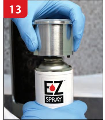
13 Retire la copa metálica del cilindro y la copa de plástico de llenado.
