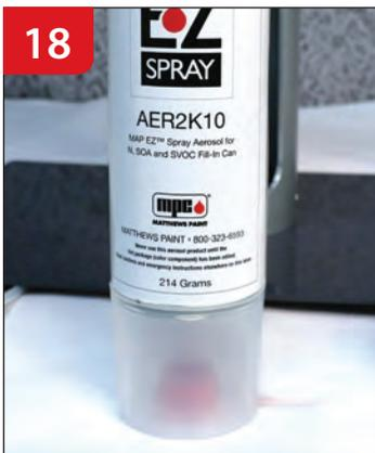
18 Coloque la tapa con el tapón rojo en la parte inferior de la lata de aerosol.
