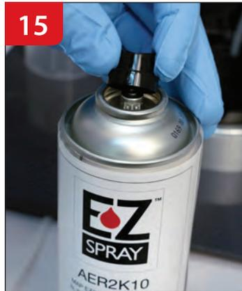
15 Oriente la boquilla de pulverización en dirección opuesta a usted y reemplácela.
