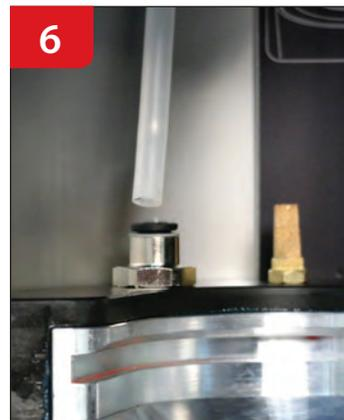
Fije la línea al conector en el interior de la máquina de llenado.
